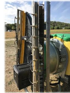
Fan air flow control
