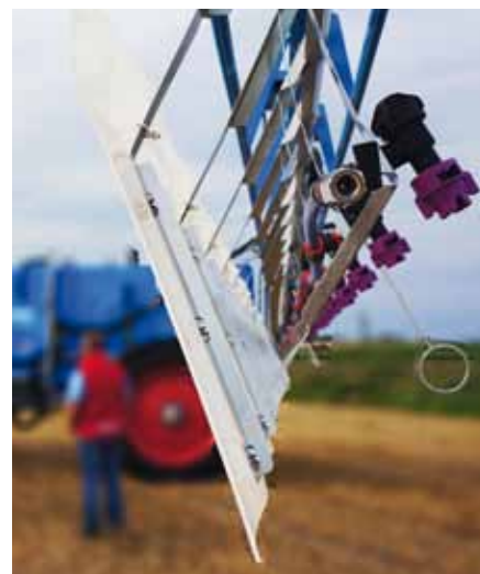
▲ Pulvérisateurs avec lame qui oriente la pulvérisation Cropsurfer (Vibby Teknik).
